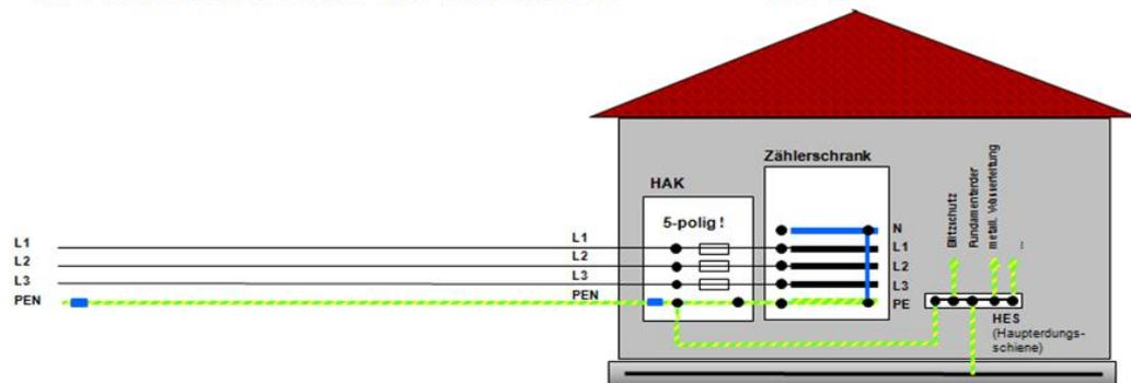
Abb. 19: Anschlussvariante bei VN Plauen zur Innenanschlusstechnik (beispielhafte Darstellung)
