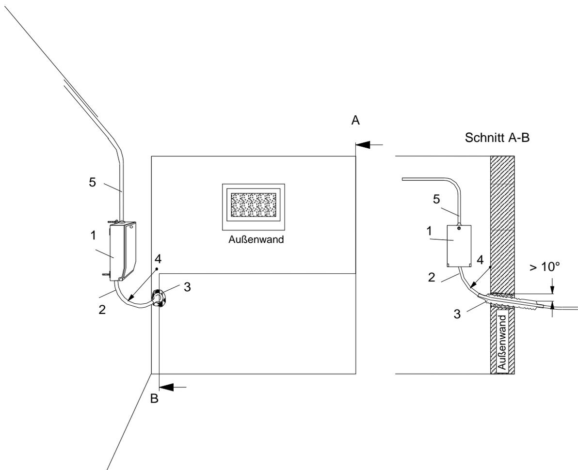
Abb. 6: Beispiel für einen Kabel-Netzanschluss, Innenanschlusstechnik
