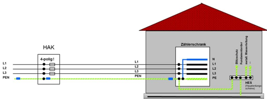
Abb. 17: Anschlussvariante bei VN Plauen zur Außenanschlusstechnik (beispielhafte Darstellung)
