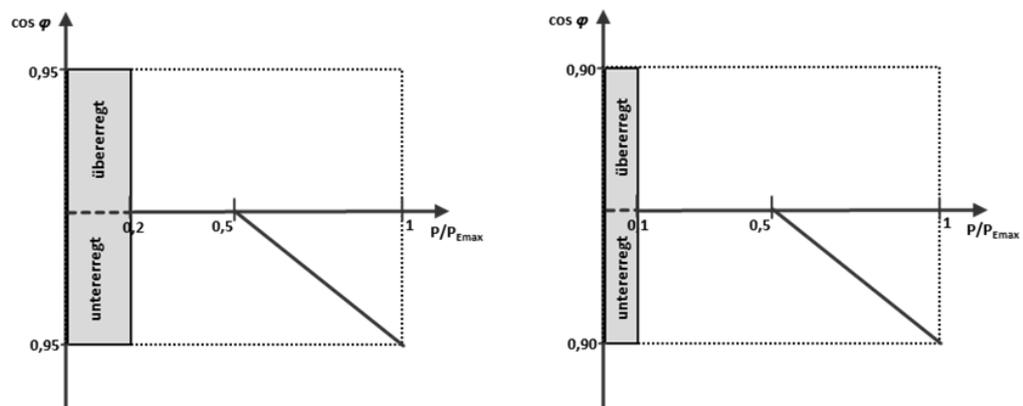
Abb. 16: Standard - Kennlinie für  $\cos \varphi (P)$
